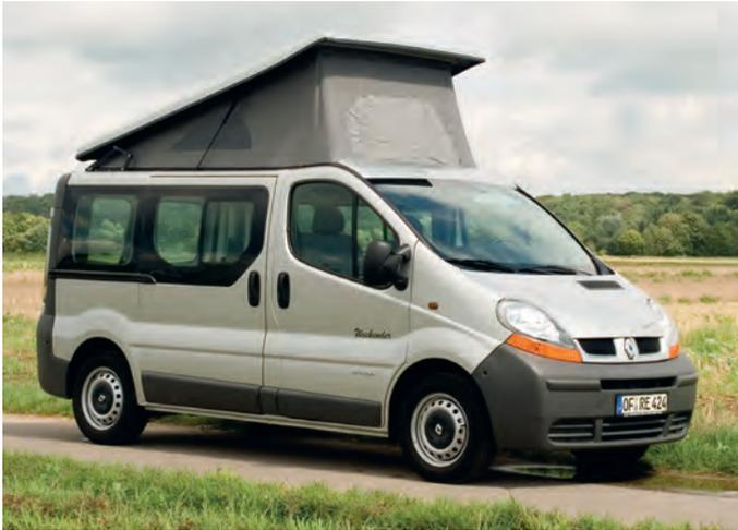
Gasfederunterstützt, Dachaufstellung vorne hoch. 2-tlg. mit Front-Fenster, Aufnahme von Aktivschiene möglich, ohne zusätzl. Fahrzeugerhöhung. Moskitonetz mit Reißverschluss. Die Front kann mit Reißverschluss geöffnet werden. Fahrzeughöhe mit Dach ca. 200 cm. Himmel (100% Polyester), Zeltbalg grau (100% Baumwolle). Mit Teilegutachten\*.
