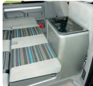
Küchenteil mit Kocher, Glasabdeckung und Technik. Anschlussfertig installiert und für den Einbau im Fahrzeug vorbereitet. Maße: H737 x B510 x T390 mm.
