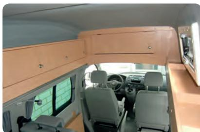
Die klassische Innenverkleidung mit Verkleidungsplatten: Hier muss mit Sikaflex-Kleber ein Lattengerüst auf die Schale aufgeklebt, dann isoliert und daran die Holzverkleidung befestigt werden.
