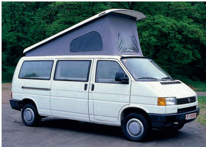
Gasfederunterstützte Dachaufstellung vorne hoch. Mit Teilegutachten\*. Stehhöhe bei geöffnetem Dach ca. 195 - 245 cm. Fahrzeughöhe ca. 6 cm. Integrierte Regenrinne. 3 Fenster im Zeltbalg (1 davon mit Folie), Moskitonetz mit Reißverschluss. Schlaflfläche ca. 200x120 cm. Zeltbalg 100% Baumwolle. Bezug 100% Polyester. Glasschiebedach und Solarzelle möglich. Verdeckte Aufnahme der Aktivschiene ohne zusätzliche Fahrzeughöhe möglich. Dachschalenfarbe Weiß. **21121 2579,-**
