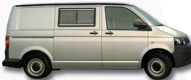
Abb. zeigt Volkswagen Transporter Kasten mit nachgerüstetem Schiebefenster
