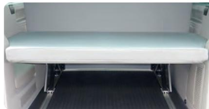
Frontblende und Seitenblende. Fertig gepolstert inkl. Heckpolster. Bank verschiebbar und herausnehmbar. Schienenabstand 997 mm
