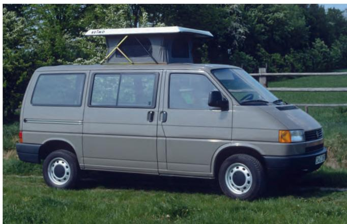
Stehhöhe im Eingangsbereich (bei geöffnetem Dach) ca. 190 cm. Dachaufstellung Gasfederunterstützt. 2 seitliche Fenster mit Moskitonetz, 1 in der Front integriertes Folienfenster. Inkl. Einbaurahmen. Fahrzeughöhe ca. 6 cm. Dachmaße ca.: L175 x B130 x H9 cm. Dachausschnitt ca. L107,5 x B101 cm. Zeltbalg 100% Baumwolle. Hubdach-Position zwischen B- und C-Säule. Dachschalenfarbe Weiß. Inkl. Teilegutachten\*. (Lieferzeit ca. 4-6 Wochen) **21210 1379,-**
