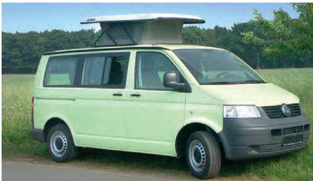
Für Volkswagen Transporter T6/T5, kurzer oder langer Radstand, ab Baujahr 2003. Mit Teilegutachten\*. Parallel und Gasfederunterstützt aufstellend. Innenraum-Erhöhung ca. 45 cm. 3 verschließbare Zeltstoff-Fenster mit Moskitonetzeinsatz. Zeltbalg grau, 100% Baumwolle. Dachausschnitt ca. L106 x B101 cm. Fahrzeughöhe ca. 7 cm. Dachmaß ca. L170 x B130 x H11 cm. Packmaß 139 x 172 x 15 cm. Gewicht ca. 37 kg. Dachschalenfarbe Weiß (R9002). **21185 1449,-**
