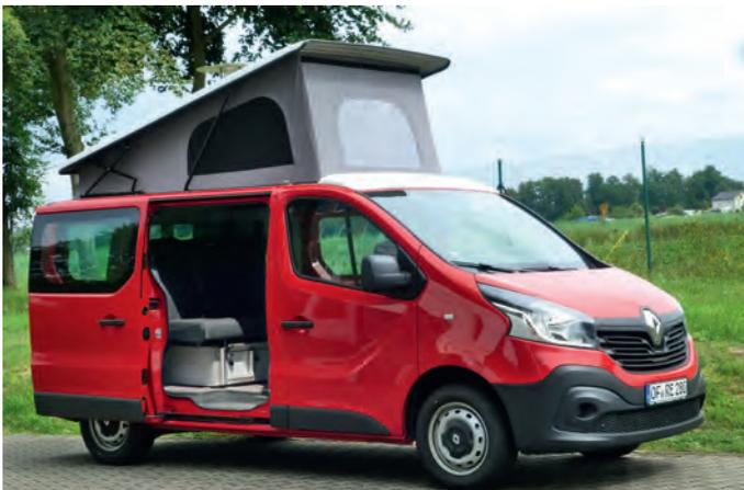
Gasfederunterstützt, Dachaufstellung vorne hoch. Mit Front- und 2 Seitenfenster. Die Front kann mit Reißverschluss geöffnet werden. Seitenfenster mit Moskitonetzen. Himmel (100% Polyester), Zeltbalg grau (100% Baumwolle), inkl. Einbaurahmen. Dachschalenfarbe Weiß. Mit Teilegutachten\*.
