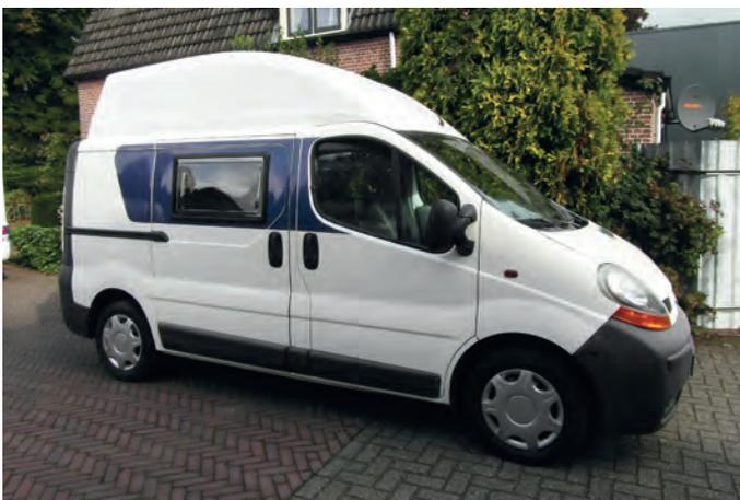
Sportlich, aerodynamisch, Van-Charakter. Stehhöhe im Dach ca. 185 cm. Fahrzeugerhöhung ca. 60 cm, Schalenhöhe 63 cm.
