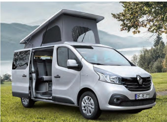
Gasfederunterstützt, Dachaufstellung vorne hoch. Inklusive Frontspoiler. Fahrzeughöhe inklusive Schlafdach ca. 207 cm. Mit Front- und 2 Seitenfenstern. Die Front kann mit Reißverschluss geöffnet werden. Seitenfenster mit Moskitonetzen. Himmel (100% Polyester), Zeltbalg grau (100% Baumwolle). Stehhöhe vorn 225 cm, hinten 140 cm. Mit Teilegutachten\*. Dachschalenfarbe Weiß
