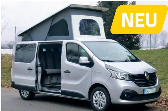
Gasfederunterstützt, Dachaufstellung hinten hoch. Mit Front- und 2 Seitenfenster. Die Front kann mit Reißverschluss geöffnet werden. Seitenfenster mit Moskitonetzen. Himmel (100% Polyester), Zeltbalg grau (100% Baumwolle), inkl. Einbaurahmen. Dachschalenfarbe Weiß. Mit Teilegutachten\*.
