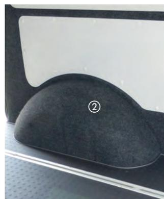
Sinn der Innenverkleidung ist es, die zerklüftete Fahrzeug-Karosserie innen so zu verkleiden, dass eine wohnliche Atmosphäre im Fahrzeug entsteht und gleichzeitig das Isolationsmaterial zwischen Fahrzeugblech und Innenverkleidung verdeckt wird. Das Verkleidungsmaterial muss sich daher der Karosserie-wölbung gut anpassen können.
