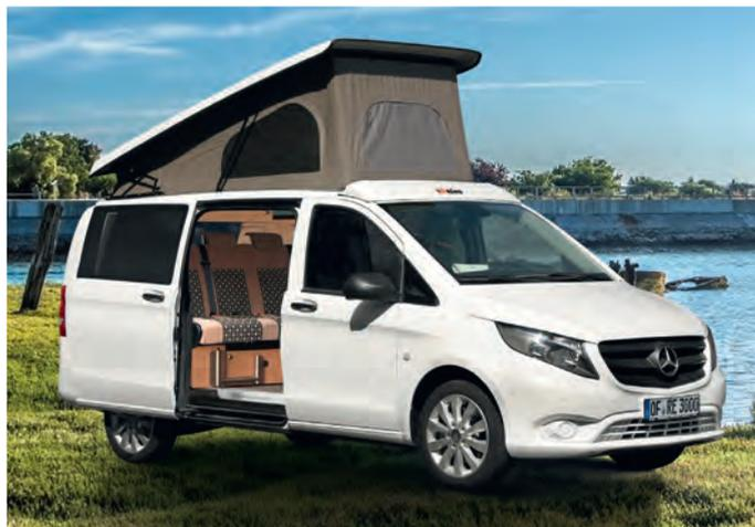
Gasfederunterstützte Dachaufstellung vorne hoch. Fertig vormontiert, inkl. Frontspoiler. 2 seitliche Fenster (Moskitonetz herausnehmbar), 1 in der Front integriertes Folienfenster. Fahrzeughöhe inkl. Dach ca. 197 cm. Stehhöhe ca. 170 - 222 cm. Zeltbalg 100% Baumwolle. Mit Integral-Verstärkungsrahmen. Dachschalenfarbe Weiß
