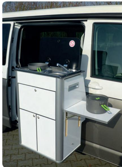
Schwenkküchenteil zum Einbau hinter den Beifahrersitz in VW T5/T6 Kombi/Caravelle (nicht passend für Multivan und California Beach). In Verbindung mit einer Reimo-Schlafsitzbank V3000 ist die volle Bettlänge nutzbar.
