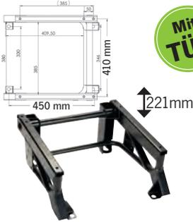
Montage anstelle des Original-Untergestelles für die Baureihe X250 (Ducato 250, Boxer, Jumper). Ideal in Verbindung mit Drehkonsole. Dieser Sockel ist ca. 40mm flacher als das Original-Untergestell. Ohne Batterie. Ab Bj. 2006
