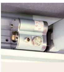
*Konstruktion mit regulierbarer Neigung der Gelenkarme von 5 Grad bis 17 Grad, um sich der Höhe des Wohnmobiles anzupassen*
