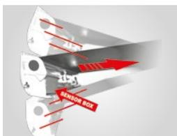
**Wind-Detection System:** fährt die Markise automatisch bei starkem Wind ein
