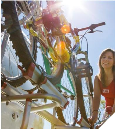
Die Carry-Bikes werden aus Rohren mit eloxiertem Aluminium hergestellt. Die verstärkten Rohre bieten auf lange Sicht optimalen Schutz und Sicherheit. Schrauben aus hochwertigem Edelstahl sorgen für eine bessere Langlebigkeit des Trägers. Fast alle Carry-Bike von Fiamma haben die Rail Quick Schiene und die Sicherheitsriemen Quick Safe. Einige Ausführungen gibt es serienmässig mit der Rail Premium.
