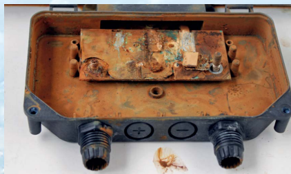
Wenn Feuchtigkeit eindringt ist das Solarmodul irreparabel...
