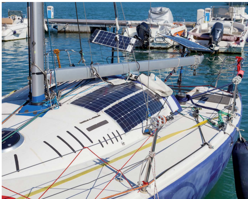
Für den Marine-Einsatz gibt es spezielle, begehbare Ultraflach-Module, die direkt auf das Deck aufgeklebt werden.
